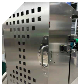
Cesto di scarto con serratura automatica Sempre in acciaio, ma con chiusura comandata dal pannello di comando.
