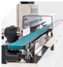
Tunnel di protezione Essenziale per gli standard GMP nel farmaceutico. Garantisce igiene e sicurezza.
