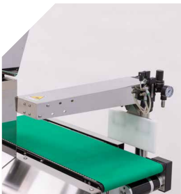
Spintore pneumatico senza cilindro Perfetto per scartare reti di frutta e verdura o prodotti pesanti.
