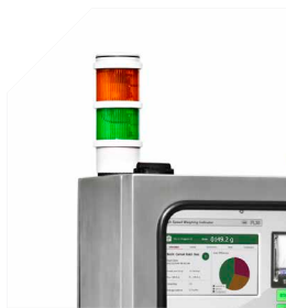
Dispositivi di sicurezza Come le torrette di allarme acustico/luminoso per segnalare anomalie e il pressostato per i cali di pressione dell'aria.
