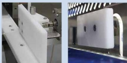
» **L'X5 SideShoot** viene fornito di serie con due segnali di uscita adatti per l'attivazione di sistemi di scarto di terze parti.
