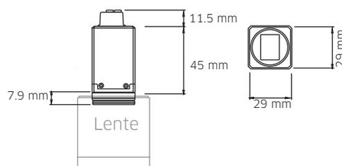
Tutte le dimensioni sono espresse in millimetri. Disegno non in scala, valido solo a fini illustrativi.
