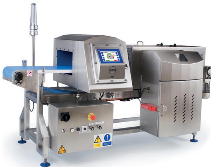
Tutelare i propri consumatori e la propria azienda è un dovere e una necessità: il sistema metal detector IQ4 rende la ricerca dei corpi estranei di origine metallica semplice, rapida e sicura.
