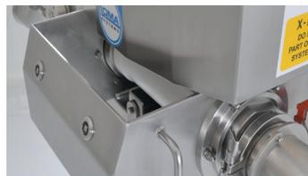
**Cassetto estraibile per una facile pulizia.** Il cassetto è progettato per rendere semplice le operazioni di pulizia e permette l'intercambiabilità dei tubi da 2.5" a 3".
