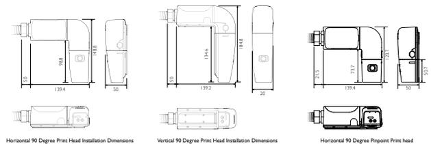
Tutte le dimensioni sono espresse in millimetri. Disegno non in scala, valido solo a fini illustrativi.
