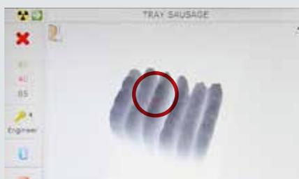
Al controllo vengono rilevati frammenti di 0,6 micron di metallo
